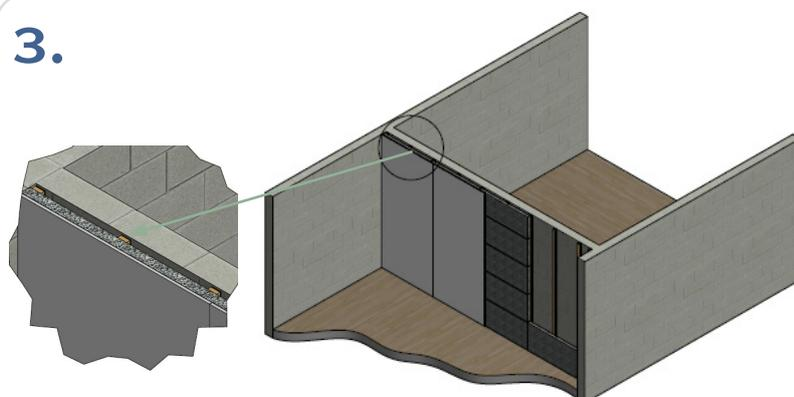
Gipskarton-/ oder Spanplatten auf die Lattung schrauben.
