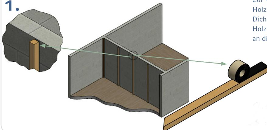
Zur Vermeidung einer Schallbrücke zwischen Holzlattung und Wand, empfehlen wir unser Dichtungsband soni\_NBR auf beiden Seiten der Holzlatten anzubringen und diese anschließend an die Wand zu dübeln.
