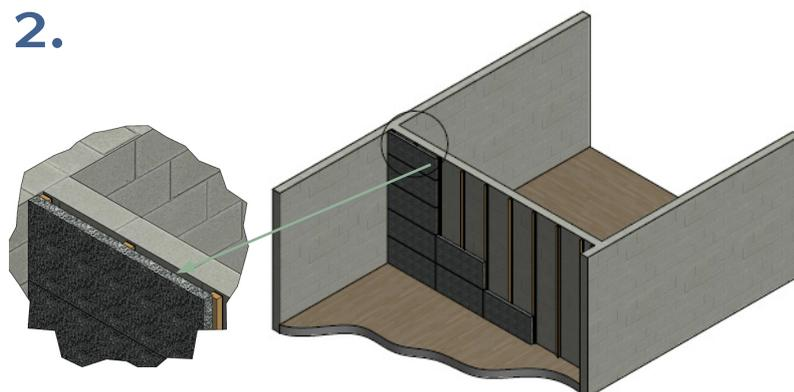
Den Hohlraum anschließend mit den Platten soni\_COMPOSITE oder soni\_491\_STL befüllen.
